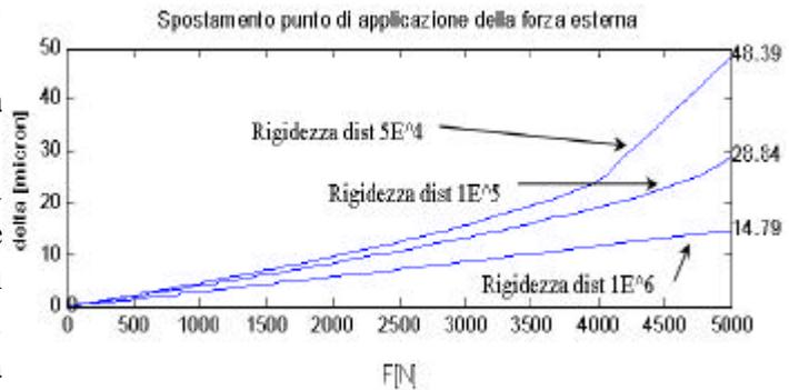
Fig. 11 Comportamento della struttura in funzione della rigidità del distanziale 2
