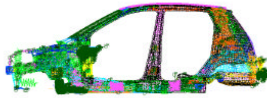
Fig.2 Modello FEM della scocca dotato delle modifiche relative ai fissaggi
