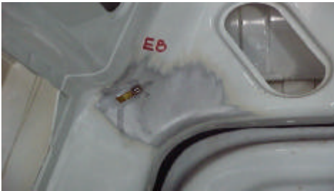
Fig. 2 Estensimetro posizionato sul montante del portellone laterale
