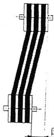
Alberi paralleli, pulegge non allineate
